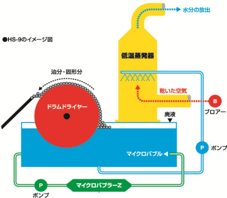
油分・固形分は**マイクロバブル**で浮上させる
